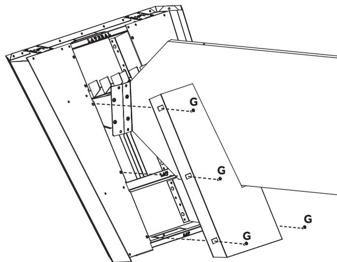
4. Coloque a calha superior do pé, e parafuse pelos rasgos com os parafusos M5x12(F). Utilize as tampas plásticas(M), para tampar os rasgos das calhas.
