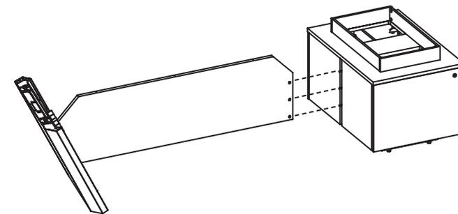
3. Por baixo, coloque a calha inferior do pé, e parafuse pelos rasgos com os parafusos M5x12(F). Utilize as tampas plásticas(M), para tampar os rasgos das calhas.
